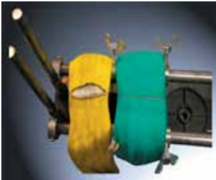
Vergleich Rundschnlle Solution und Duplix Inox: nach 300 Schneidintervallen
